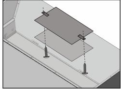
9. Placez la plaque supérieure rectangulaire sur l'ouverture du boîtier. NOTE : Assurez-vous que les languettes de la plaque se trouvent sur le dessus de la plaque, comme illustré. Fixez la plaque sur le dessus du boîtier à partir de l'intérieur à l'aide des (2) vis 3/16 x 3/8.
