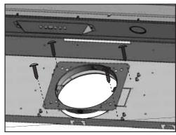
10. (Conduit circulaire) À partir de l'intérieur du boîtier, installez l'adaptateur circulaire de 8" dans l'entrée défonçable arrière et fixez-le à la paroi intérieure arrière du boîtier à l'aide de (4) vis M4 x 6 mm.
