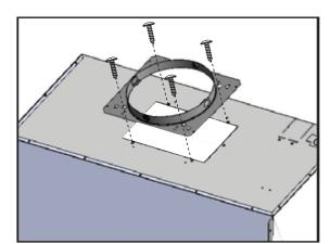
**5.** Fixez l'adaptateur circulaire de 8" à la partie supérieure du boîtier à l'aide de (4) vis M4 x 6 mm.
