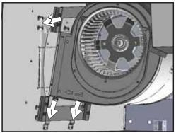
12. Placez le ventilateur à l'intérieur du boîtier, comme illustré, de la façon suivante : (1) Appuyez le support inférieur du conduit horizontal sur les deux attaches de soutien situées à l'intérieur de la paroi intérieure du boîtier. (2) Faites pivoter le support supérieur du conduit horizontal de façon à ce qu'il s'engage dans les écrous captifs de la paroi arrière intérieure.
