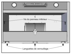
4. Enlevez le panneau inférieur de la façon suivante : (1) Enlevez les (2) vis des deux côtés du panneau inférieur. (2) Tirez le panneau inférieur vers l'avant du boîtier pour le libérer des languettes de verrouillage.
